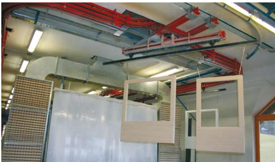
**8 –** Dopo la verniciatura del primo lato, le bilancelle ruotano e presentano la seconda faccia delle finestre al robot.
