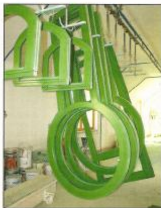
Sodobna lakirnica omogoča raznovrstnost lesenih okvirjev
